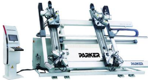
Obr. 5: Krimpovací stroj na krimpování hliníkových profilů, nejčastěji rámu dveří, oken.
