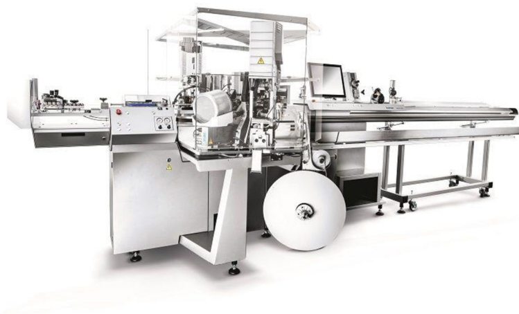
Obr. 3: Plně automatizovaný stroj na stříhání a krimpaní kabelů
