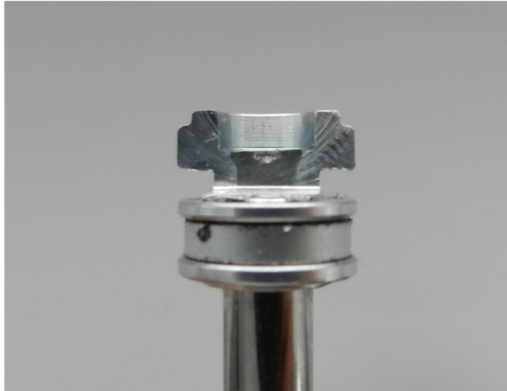
Obr. 7: Řez zakrimpované pístnice a pístu
