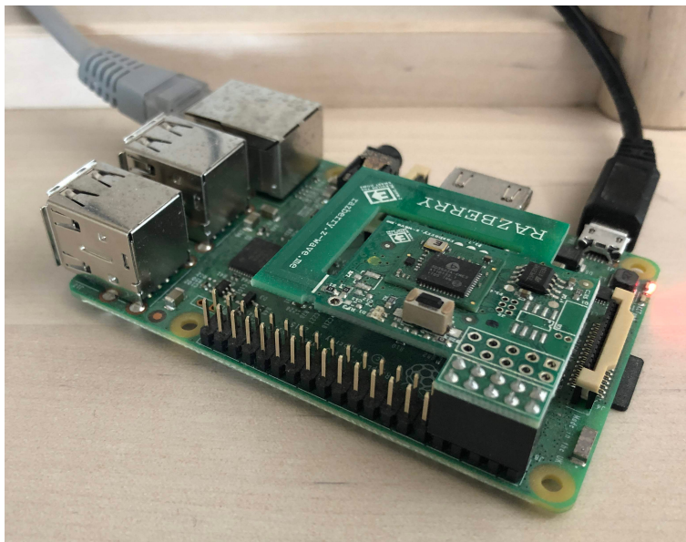
Obrázek 3.12. Z-Wave modul RaZberry na Raspberry Pi
