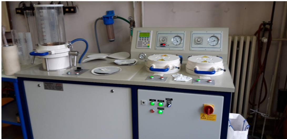
Obrázek 3.6 Laboratorní archovač (Polcar, 2021)
