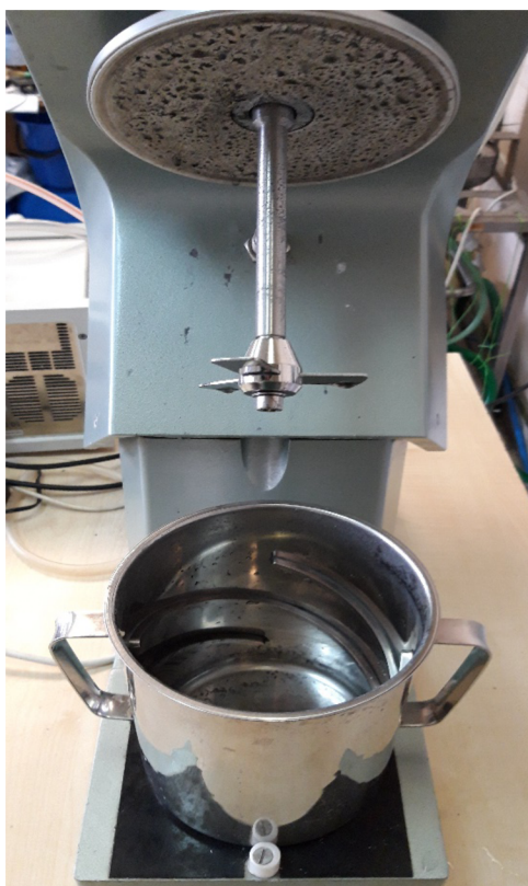
Obrázek 3.6 Laboratorní rozvlákňovač (Srp, 2021)
