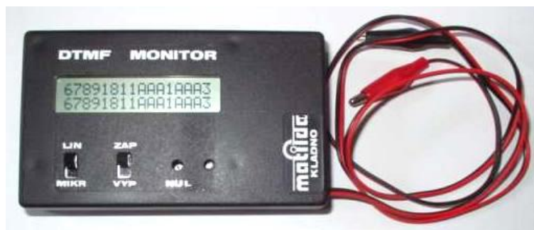
Obrázek 18: DTMF monitor Matilda
