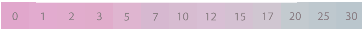
Obrázek 20: Závislost optické hustoty na vlnové délce při působení 3 mg amoniaku v časech 0 a 30 min a vizualizace změny barvy v minutách při působení 3 mg \text{NH}_3
