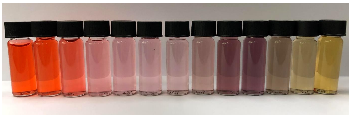
Obrázek 12: Měřené roztoky anthokyanového extraktu – pH 1–12
