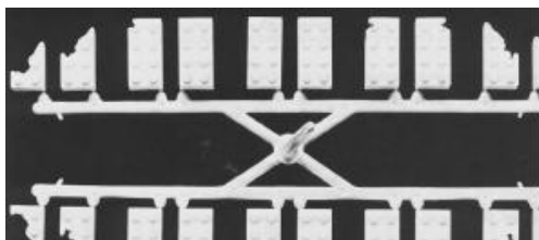
Obr. 4.4 Špatně zvolené uspořádání [20]
