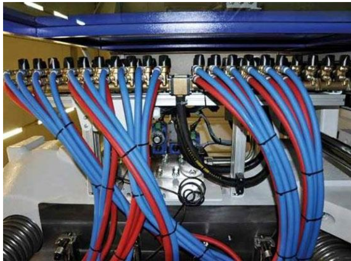
Obr. 4.17 Přívody temperační kapaliny formy [10]
