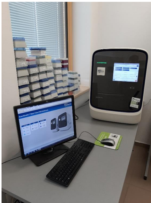
Obrázek 17: Přístroj pro Real-Time qPCR analýzu – QuantStudio 6 Flex Real-Time PCR System (Applied Biosystems)
