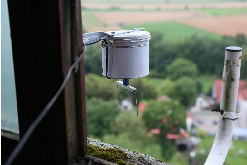
Obrázek 5: Lapač spór s rotujícími rameny Rottrap 52 (foto: Dvořák, Boršov nad Vltavou, červen 2020)
