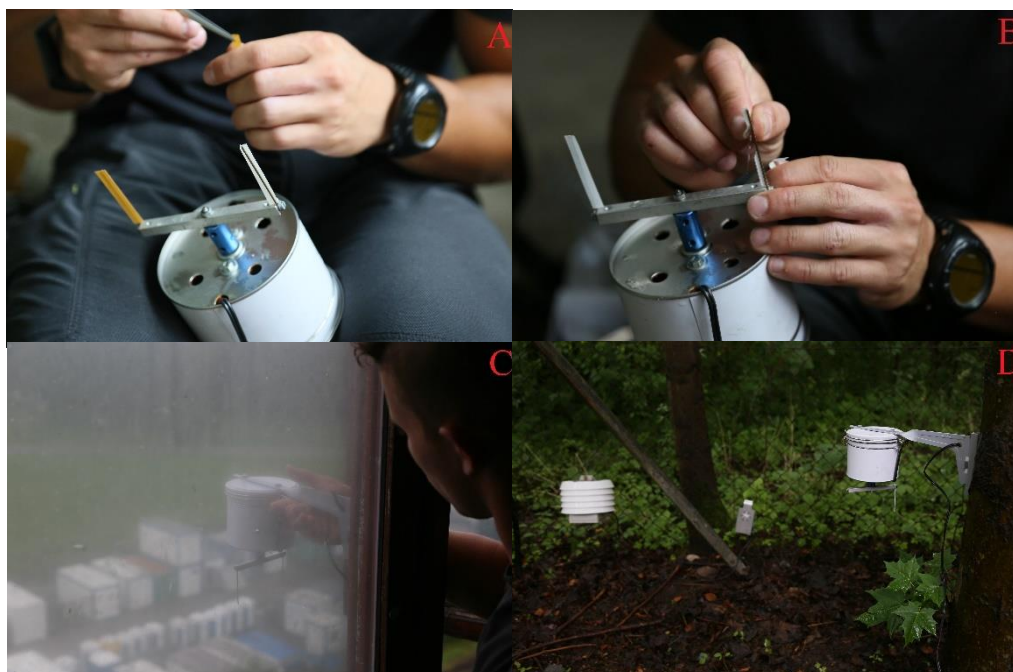
Obrázek 12: Příprava lapačů: A – připravení Tesa pásek ve směru, odstranění fólie; B – seříznutí pásky na tloušťku 0,8 mm; C – upevnění lapače na silo; D – umístění lapače u země, vedle meteorologické stanice SIGNALIZÁTOR (Amet, Velké Bílovice, ČR) měřící teplotu, vlhkost vzduchu a ovlhčení listů (foto: Dvořák, Boršov nad Vltavou, srpen 2020)
