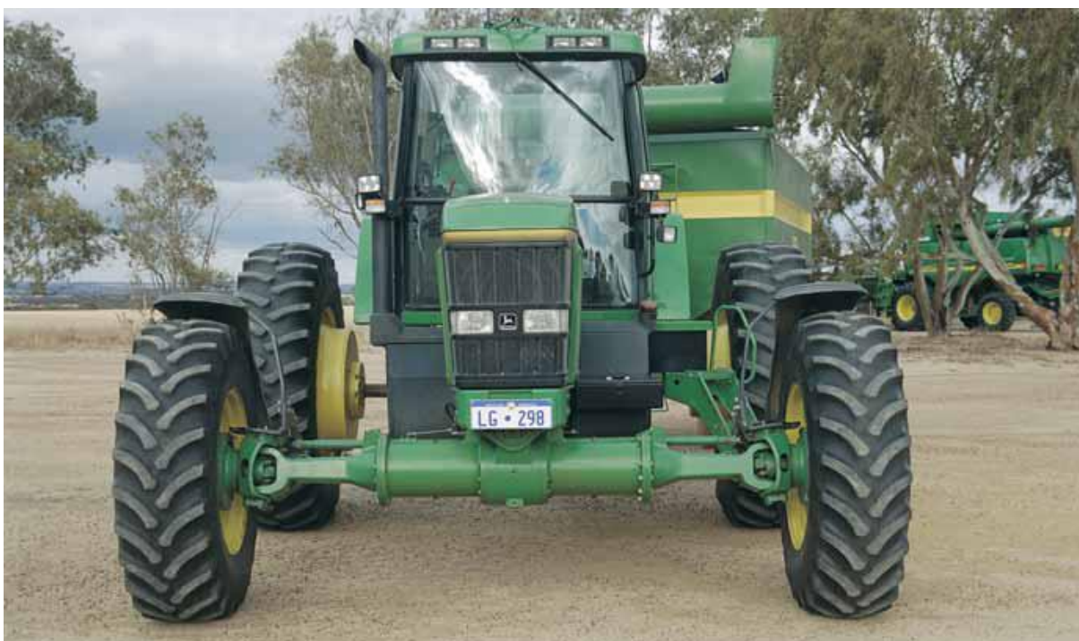
Obrázek 3. Traktor John Deer s upraveným rozchodem kol pro CTF systém
