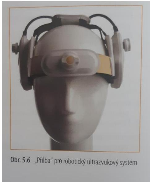
Obr. 5.6 „Přilba“ pro robotický ultrazvukový systém
