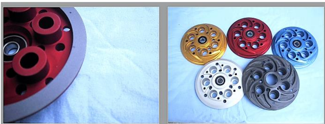
Obrázek 20 Obrobené a povrchově ošetřené dílce [21]
