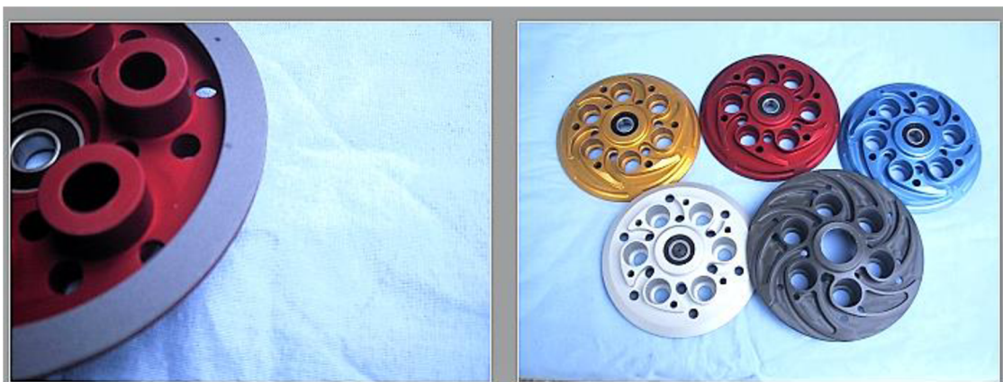
Obrázek 20 Obrobené a povrchově ošetřené dílce [21]
