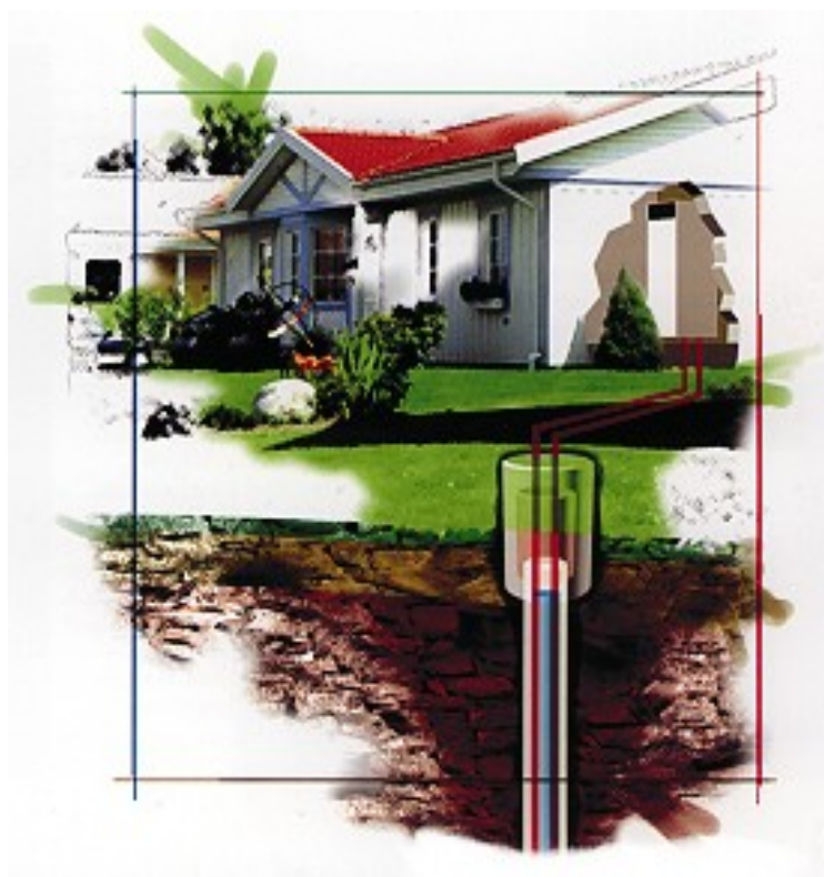
Obr. 7 Schéma napojení hloubkových vrtů pro tepelné čerpadlo
