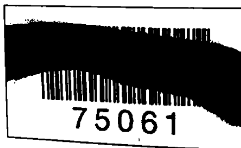
Obr. 1.5 Druhy poškození čárového kódu
