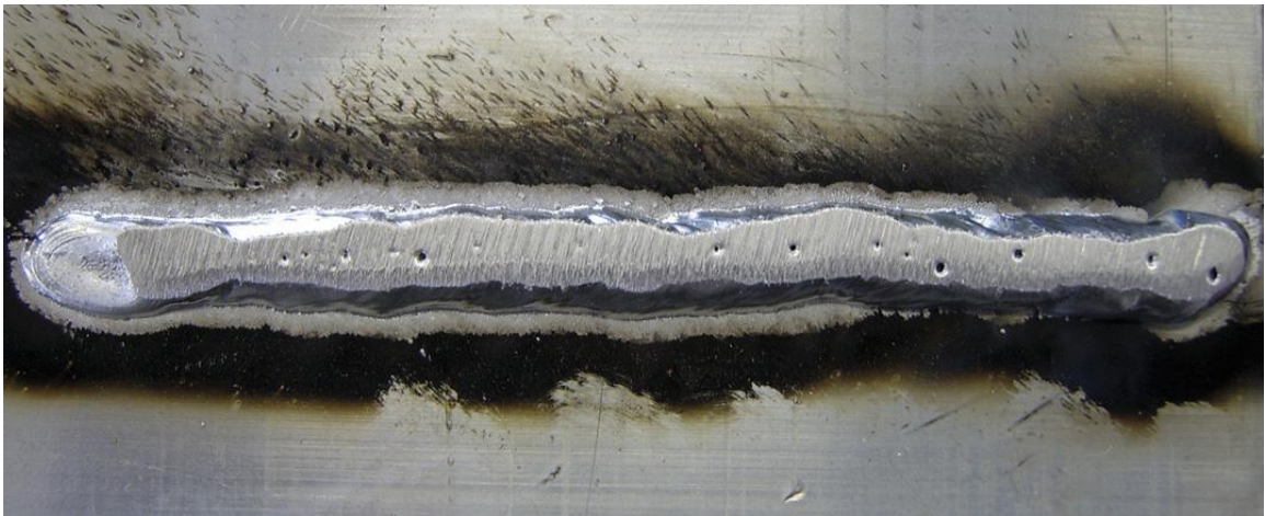
Obr. č. 1: Přímá vizuální kontrola: zjištěná vada – povrchové póry ve svaru. (Zdroj: autor práce).
