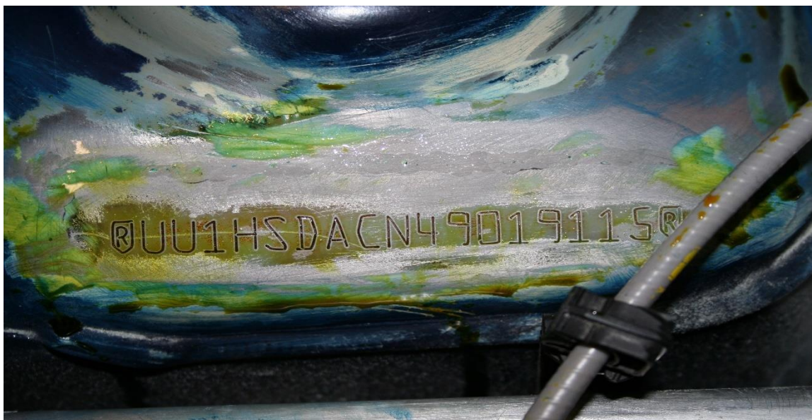
Obr. č. 10: Ukázka převařeného čísla VIN na karosérii u motorového vozidla. Zdroj: (Smejkal, OKTE Brno).
