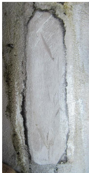
Obr. č. 15 a 16: Foto vybroušeného identifikačního čísla na rámu motocyklu bez patrných výrobních identifikačních znaků. Zdroj: (Smejkal OKTE Brno).
