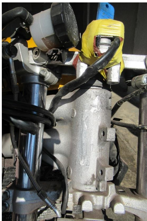
Obr. č. 15 a 16: Foto vybroušeného identifikačního čísla na rámu motocyklu bez patrných výrobních identifikačních znaků. Zdroj: (Smejkal OKTE Brno).
