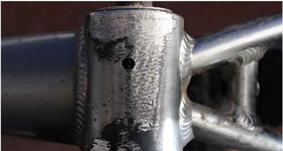
Obr. č. 9: Ukázka částečně vypilovaného vyraženého výrobního čísla pachatelem na rámu jízdného kola. Zdroj: ( https://prazsky.denik.cz/zlociny-a-soudy/podezrele-chytili-pri-brouseni-vyrobnich-cisel-kol-20150604.html ).
