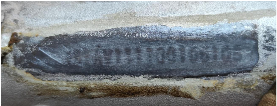
Obr. č. 17: Chemickým leptáním zviditelněné odstraněné výrobní číslo z rámu motocyklu. Zdroj: (Smejkal OKTE Brno).
