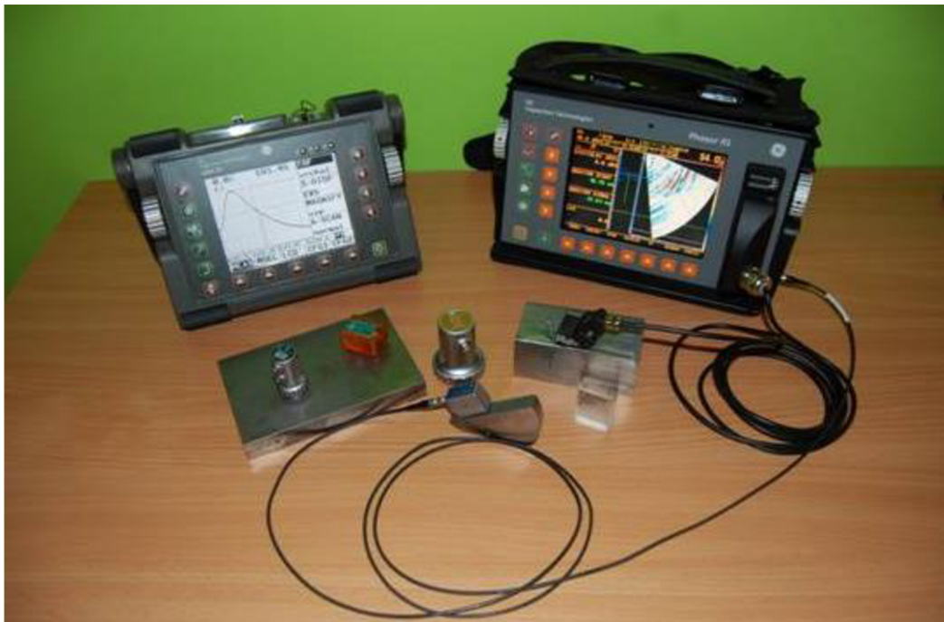
Obr. č. 4: přístroj pro provádění zkoušky ultrazvukovou metodou. Zdroj: ( http://www.ndtservis.cz/web/index.php/cz/nedestruktivni-zkouseni/ultrazvukova-metoda-ut-emat ).
