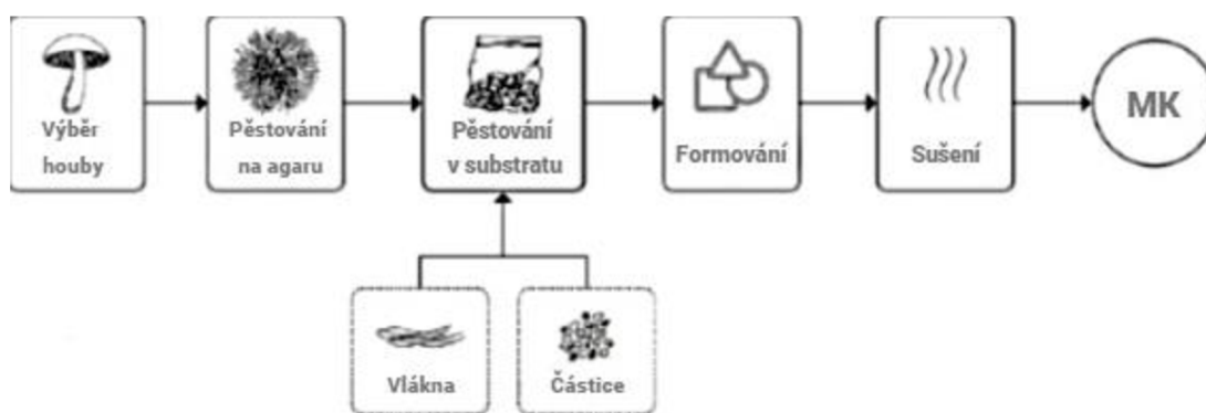
Obrázek 8: Obecný postup při výrobě MK. 38
