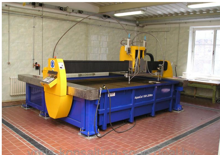
Obr. 5. Řezací systém MICROSTEP AQUACUT 1501 (Baymetik 2016)
