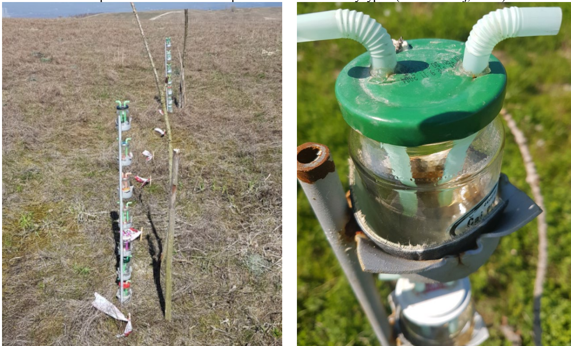
Obr. 10. Erozní lapače a detail erozního lapače na Radovesické výsypce (vlastní zdroj, 2017)
