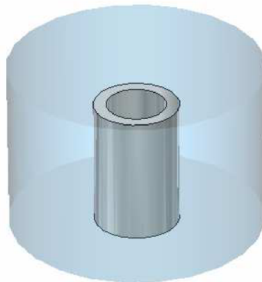
Obrázek 1.2 Koaxiální rezonátor se zvětšenou plochou středního vodiče
