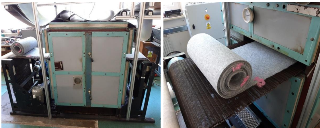
Obr. 27: Teplovzdušná komora a zpevněná finální textilie pro třetí řadu vzorků.
