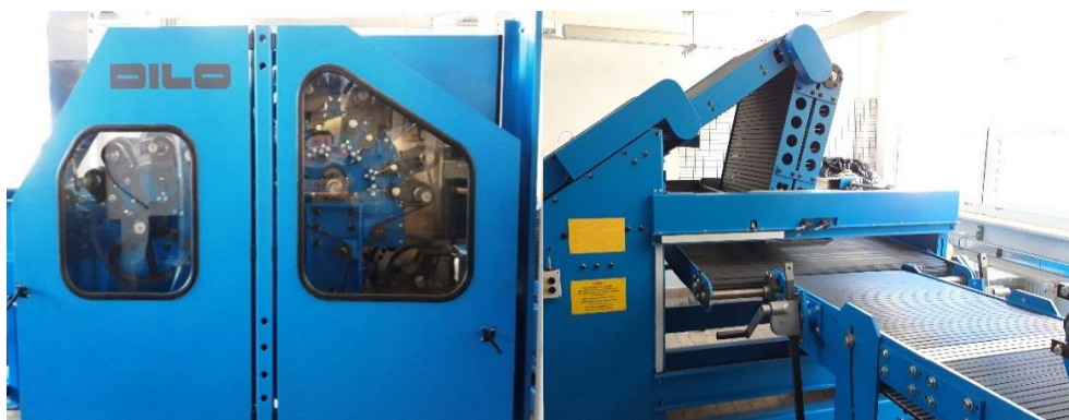
Obr. 25: Mykací stroj (vlevo) a příčný vertikální kladeč s dopravníkem ke vpichovacímu stroji (vpravo).
