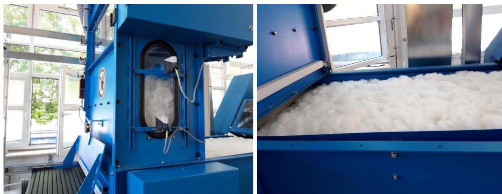
Obr. 24: Mísící komora a dopravník vlákněných vloček k mykacímu stroji.
