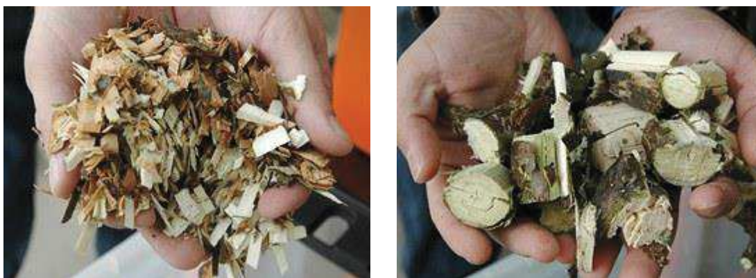
Obrázek 4 - Výsledek po použití drtiče (vlevo) a štěpkovače (vpravo) [10]
