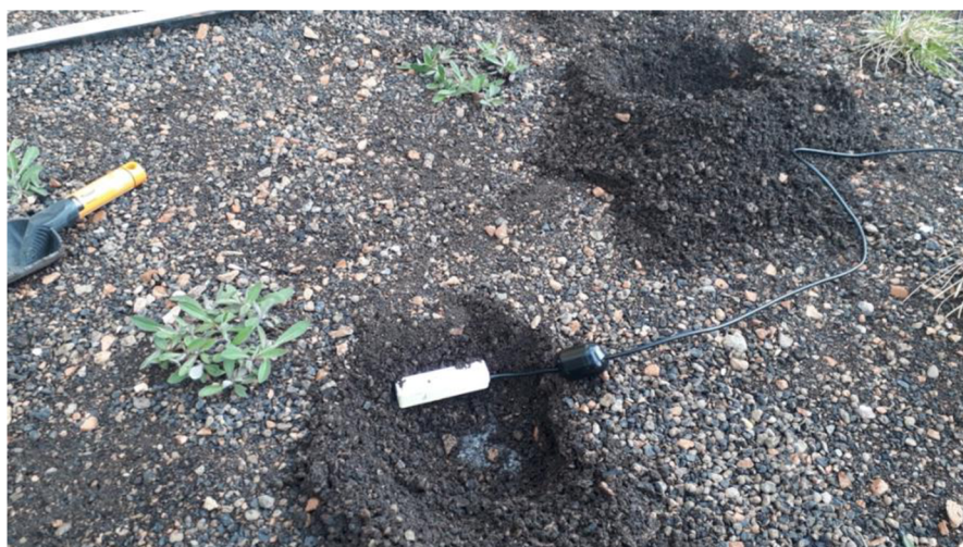
Obr. 17: Umístění senzoru Teros 11 v substrátu experimentální střechy
