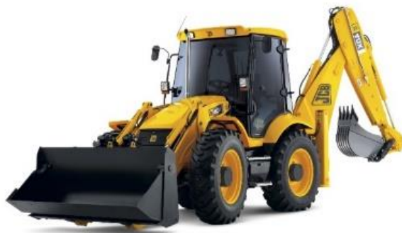
Obr. č. 39: Rypadlo – nakladač JCB 4CX ECO [20]
