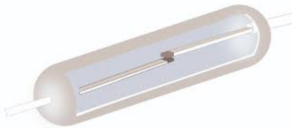
Obrázek 4.2: Jazýčkový spínač Normally open (prevzaté z [11])
