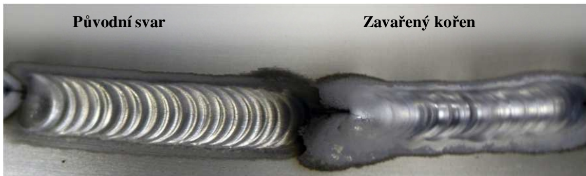
Obr. 4.33 Porovnání původního svaru a první vrstvy
