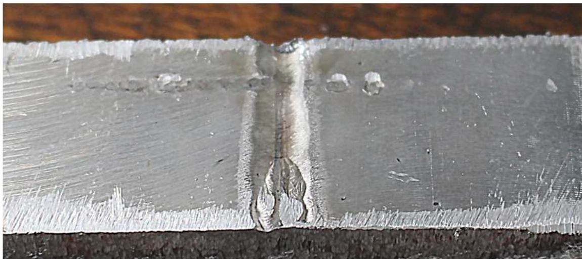
Obr 4.65b Vrub u kořene svaru vzorku 13
