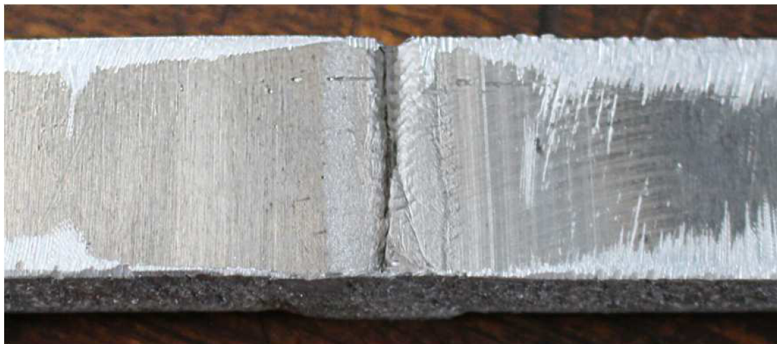
Obr 4.63b Vrub u kořene svaru na vzorku 11
