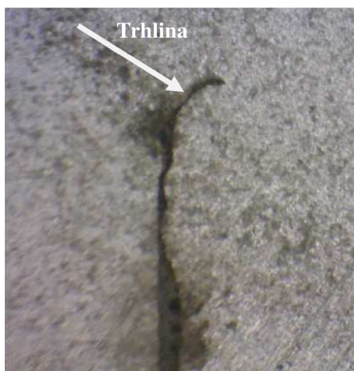
Obr 4.45b detail kořene prvního svaru.
