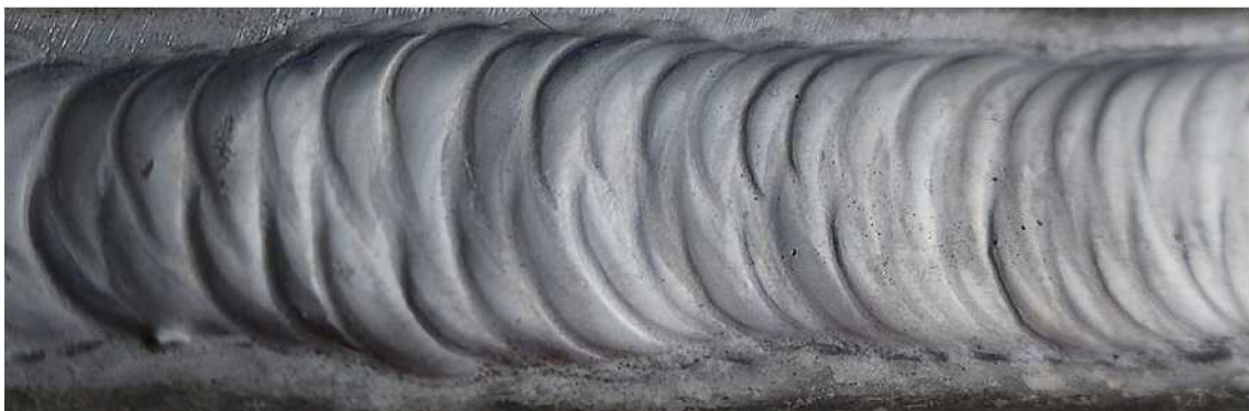
Obr. 4.63a Kresba housenky svaru vzorku 11
