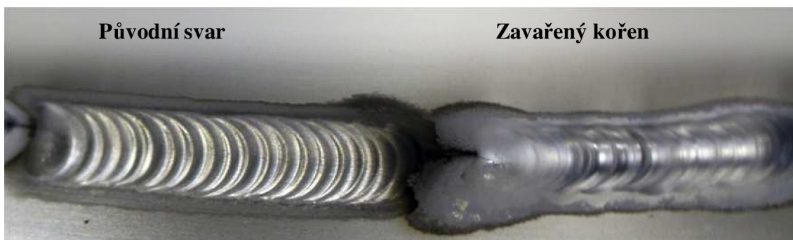
Obr. 4.33 Porovnání původního svaru a první vrstvy
