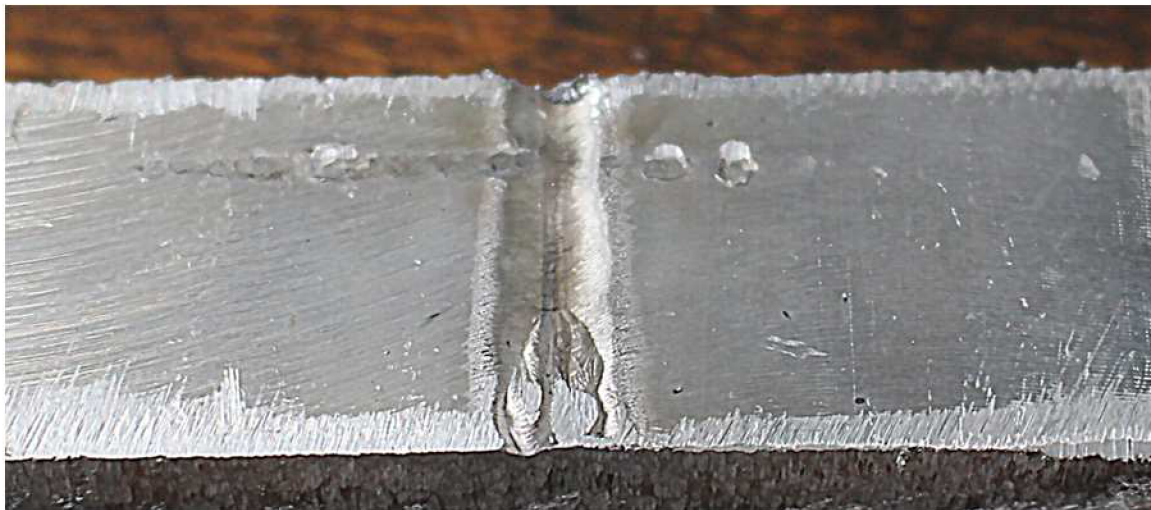
Obr 4.65b Vrub u kořene svaru vzorku 13
