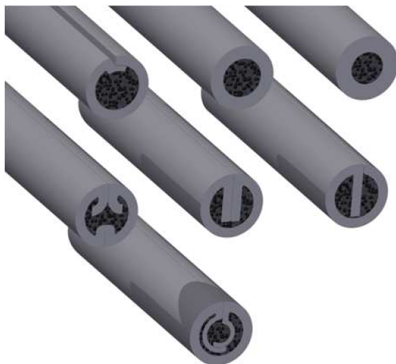
Obr 3.41 Plněné dráty se švem a bezešvé [8]
