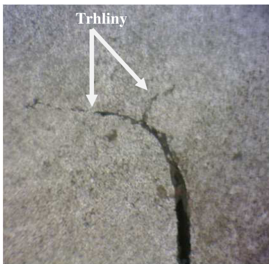
Obr 4.46b detail kořene prvního svaru.
