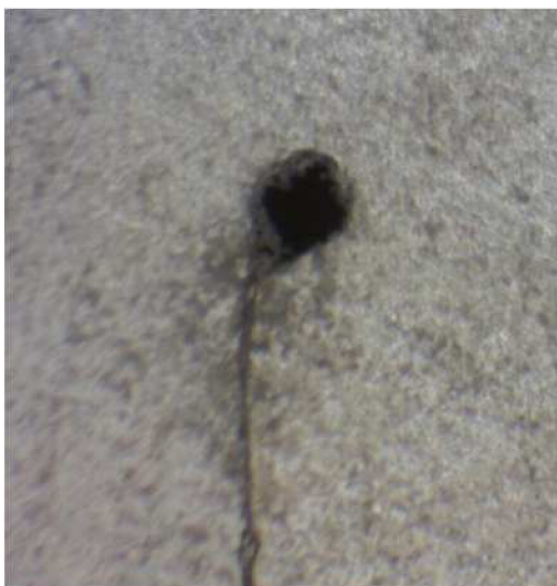
Obr 4.47b detail kořene prvního svaru.
