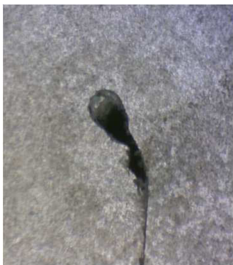
Obr 4.48b detail kořene prvního svaru.
