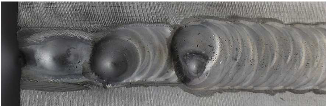
Obr. 4.65a Jednotlivé průřezy u třívrstvého svaru
