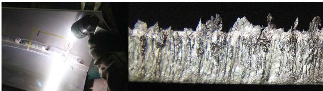
Obr. 4.41b řezání plazmovým hořákem, povrch vzorku po řezání
