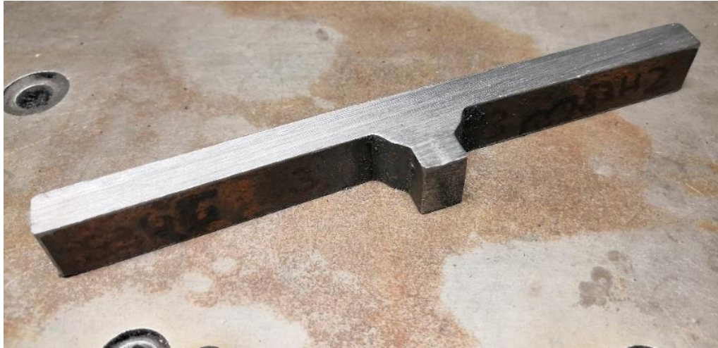
Obr. 3.11 - Vzorek po rozřezání svařence
