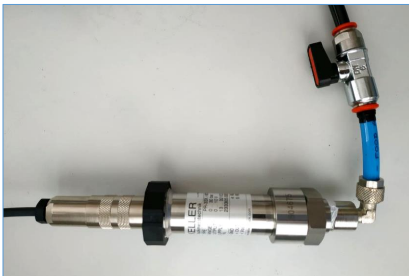
Obr. 32) Testovacia časť obvodu (tlakomer, hadička, ventil)
