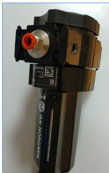
Obr. 22) Testovaný filter filter IMI Norgren F64G
