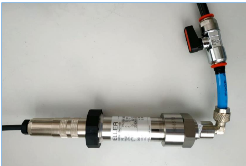
Obr. 32) Testovacia časť obvodu (tlakomer, hadička, ventil)
