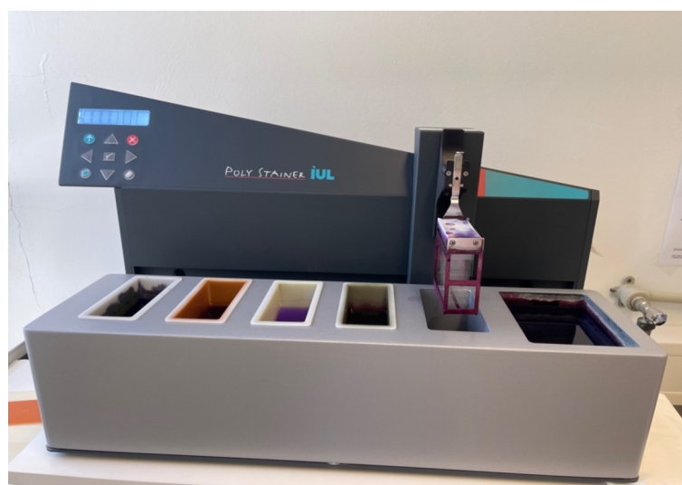
Obrázek č. 4: Barvicí automat značky Polystainer (zdroj: vlastní)
