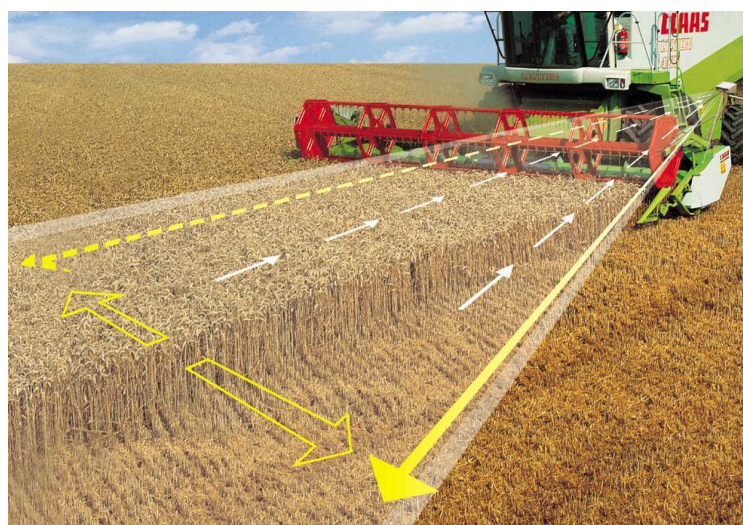
Obr. 4 Měření hrany porostu systémem LASER PILOT u sklízecí mlátičky CLAAS LEXION 480.
