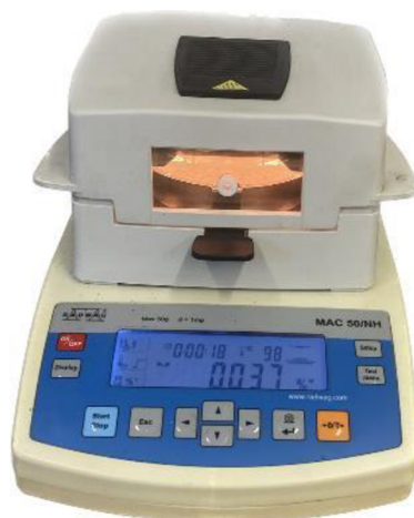
Obr. 3.7 Analyzátor vlhkosti RADWAG MAC 50/NH
