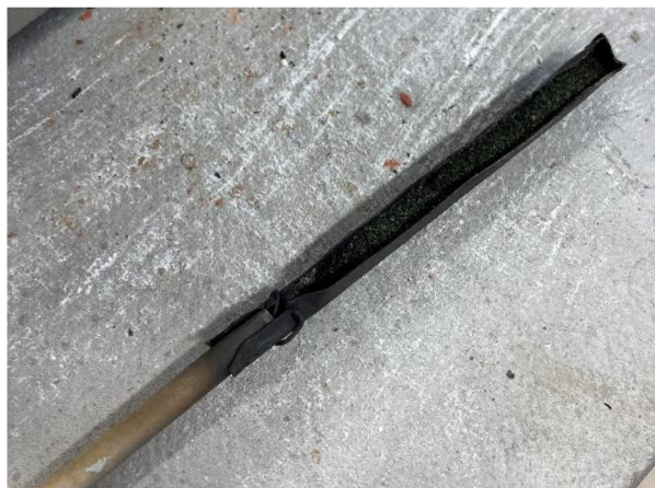
Obr. 3.14 Lodička s nevypálenou směsí
