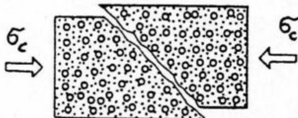
Obr. 2.4- Porušování jednosměrného dlouhoválnového kompozitu příčným tlakovým namáháním
