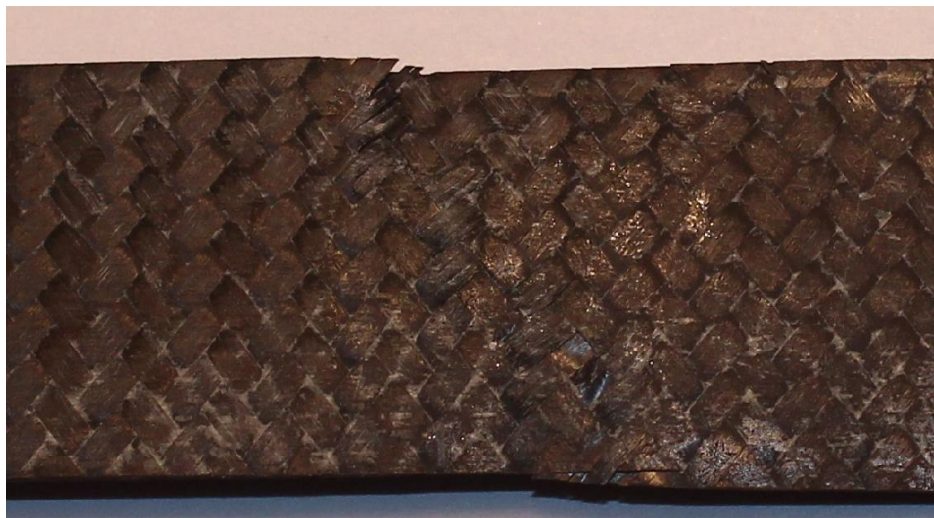
Obr.6.3- Detail poškození u vzorku po tahové zkoušce s diagonální orientací vláken
