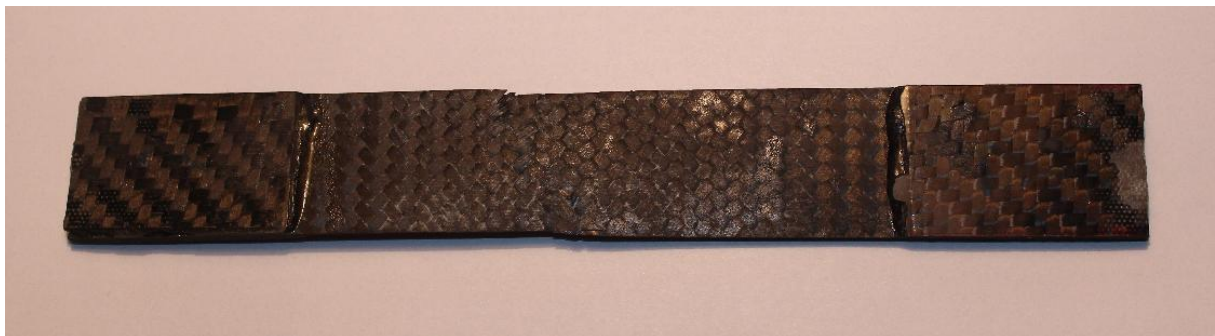
Obr.6.2- Vzorek po tahové zkoušce s diagonální orientací vláken
