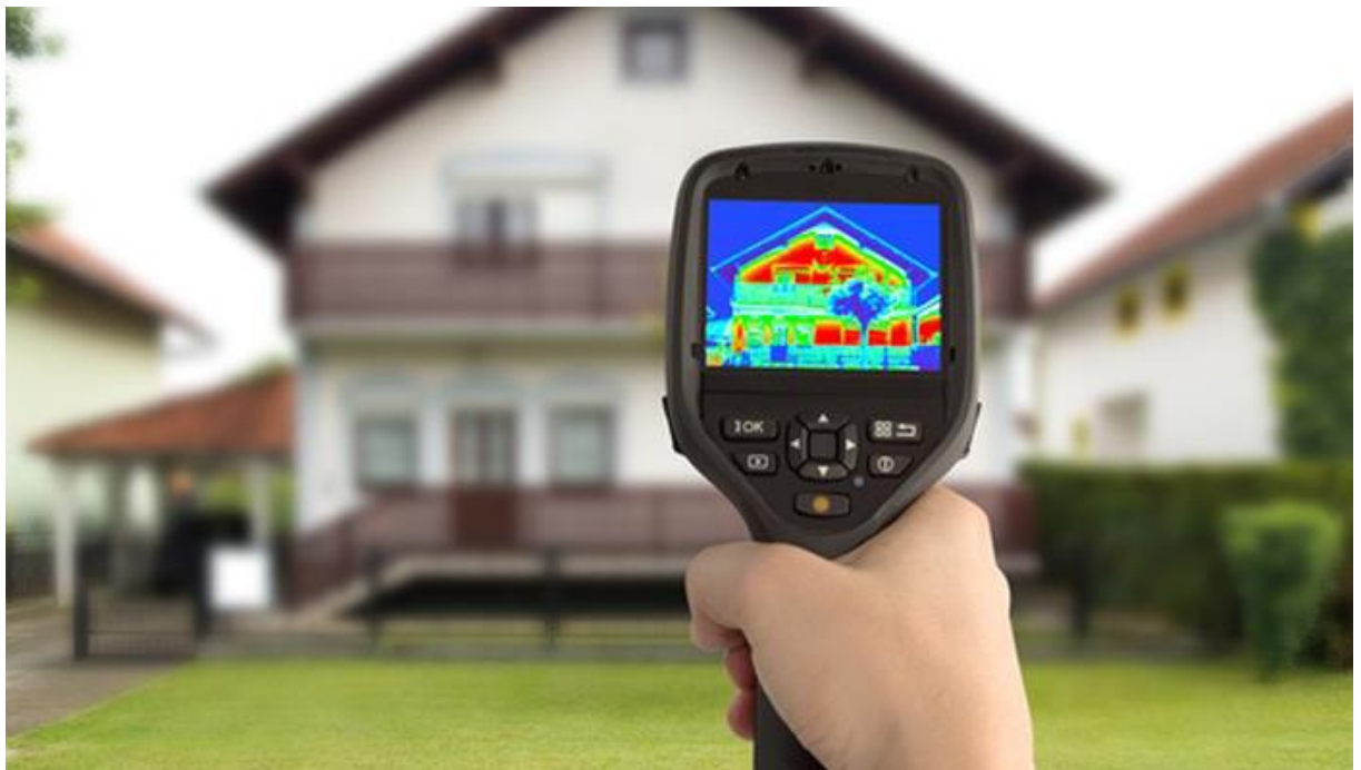
Příl. 4 Termovizní měření
