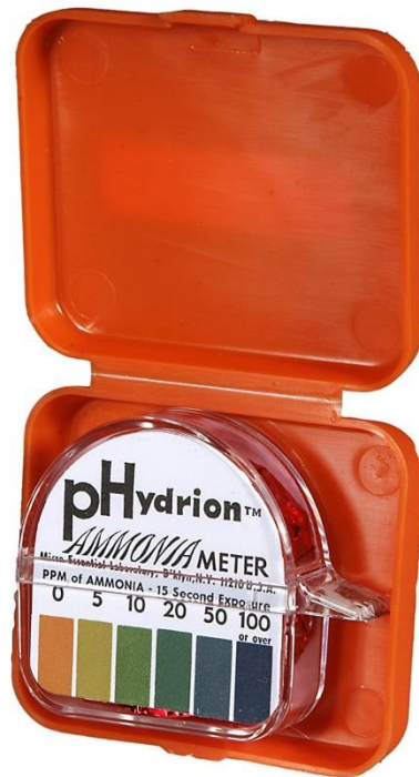
Příl. 19 Indikátorové pH papírky ke stanovení koncentrace amoniaku Micro Essential Lab AM-40 Hydrion Ammonia Meter Test
