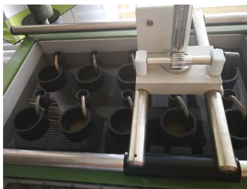
Obr.č. 17: Vzorky vložené do laboratorního permeamtru těsně před začátkem měření, zdroj: vlastní fotodokumentace ze dne 1.7.2019
