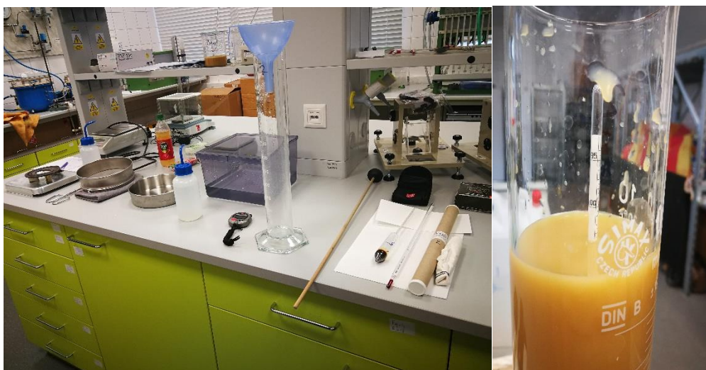
Obr. č. 21a, 21b: Příprava soupravy pro měření zrnitosti hustoměrou metodou a ryska hustoměru ve skleněném válci, zdroj: vlastní fotodokumentace ze dne 13.11.2019
