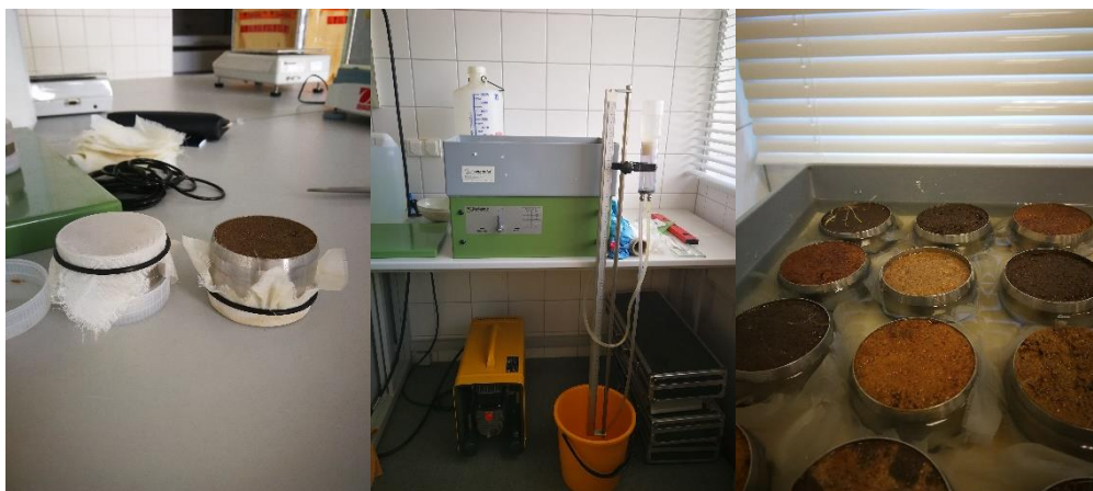
Obr. č. 15a, 15b, 15c: Příprava vzorků k měření bodů retenční křivky, zdroj: vlastní fotodokumentace ze dne 11.6.2019 a 14.6.2019
