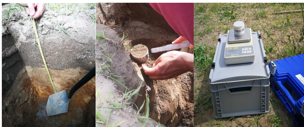
Obr. č. 13a, 13b, 13c: Dokumentace procesu odebrání neporušených půdních vzorků, zdroj: vlastní fotodokumentace ze dne 6.6.2019
