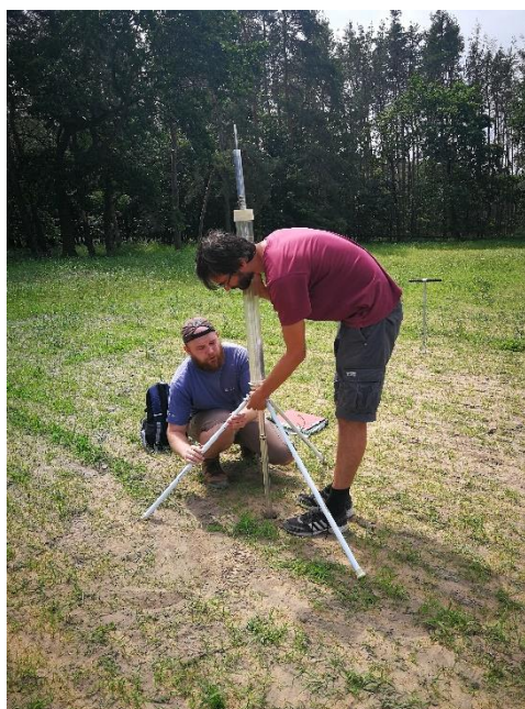
Obr.č. 14: instalace Guelphského permeametru v terénu, zdroj: vlastní fotodokumentace ze dne 6.6.2019
