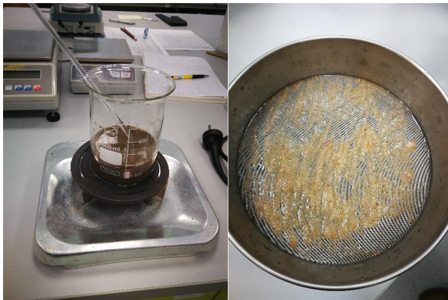
Obr. č. 20a, 20b: Aparatura pro vaření vzorku a následné přesívání větších částic, zdroj: vlastní fotodokumentace ze dne 18.9.2019
