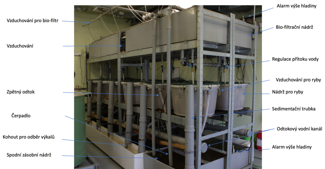
Obrázek č. 3: Schéma odchovného systému s popisem základních částí
