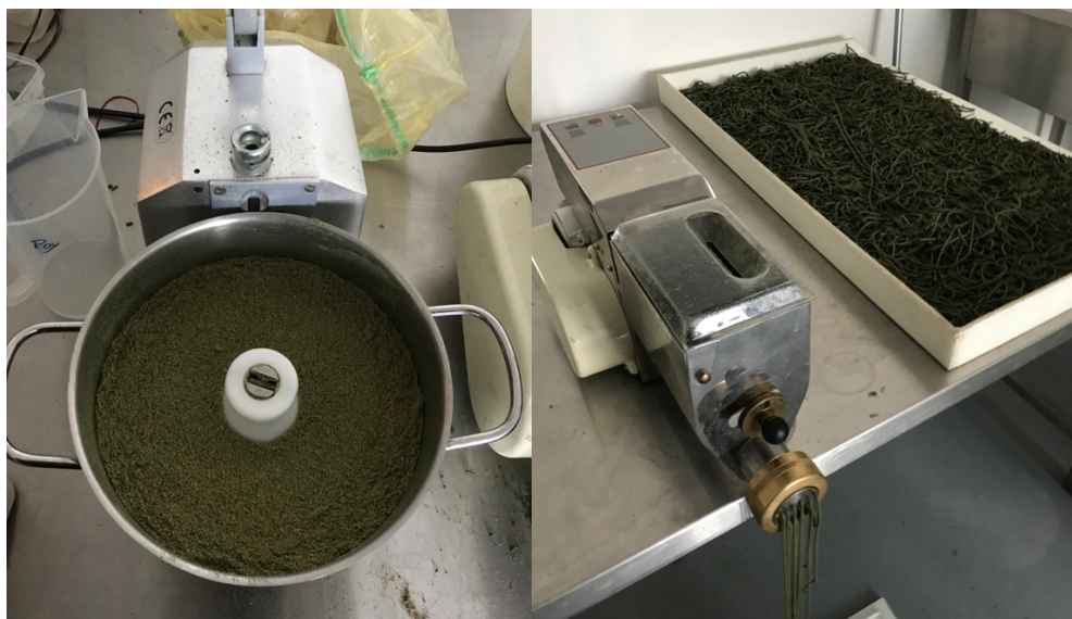
Obrázek č. 6: Vlevo namíchaná suchá směs s přidáním indikátorem. Vpravo extrudér, který za studena zpracovává již navlhčenou směs a vytlačuje dlouhé pelety, které se nechají sušit a poté se nadrtí na požadovanou velikost 3-5 mm.
