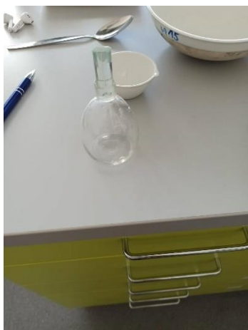
Obr. 4.2 Pyknometr použitý při pokusu
