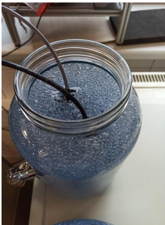
Obr. 4.9 Osazení čidel v nasycených kuličkách
