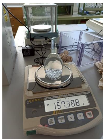
Obr. 4.3 Pyknometr naplněný kuličkami
