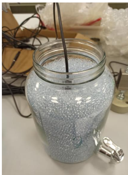
Obr. 4.7 Osazení čidel ve skleněných kuličkách
