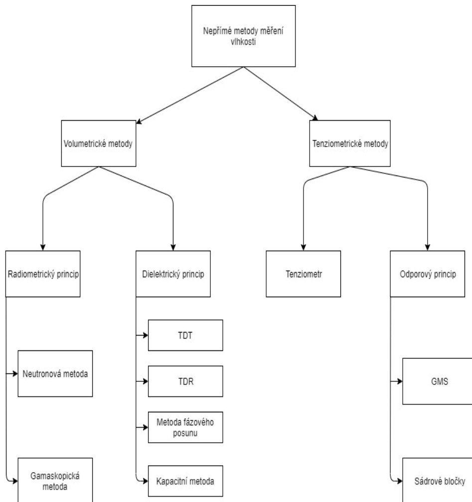
Obr. 3.1: Rozdělení nepřímých metod měření
