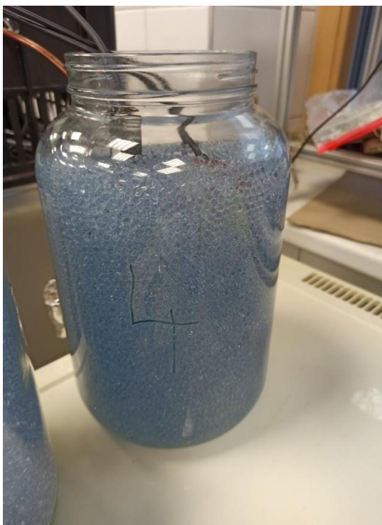
Obr. 4.10 Ponoření celých čidel do vody v nádobě 4
