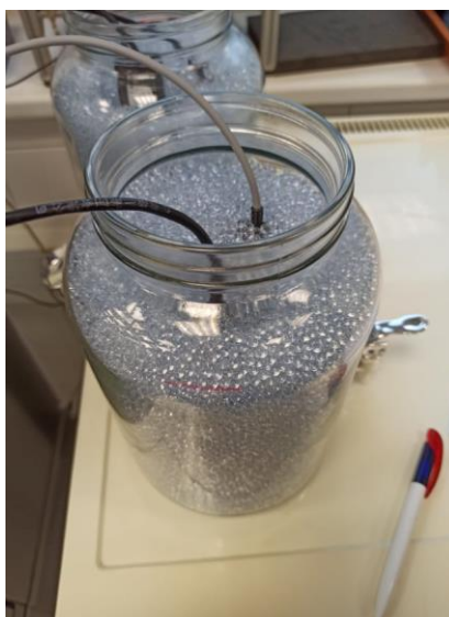
Obr. 4.8 Osazení dvou čidel ve skleněných kuličkách
