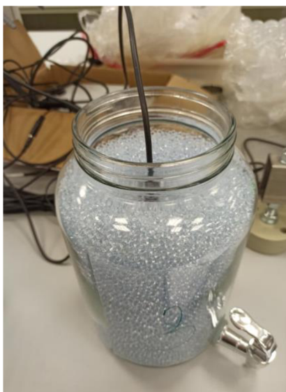
Obr. 4.7 Osazení čidel ve skleněných kuličkách
