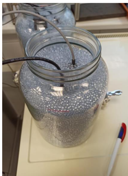
Obr. 4.8 Osazení dvou čidel ve skleněných kuličkách
