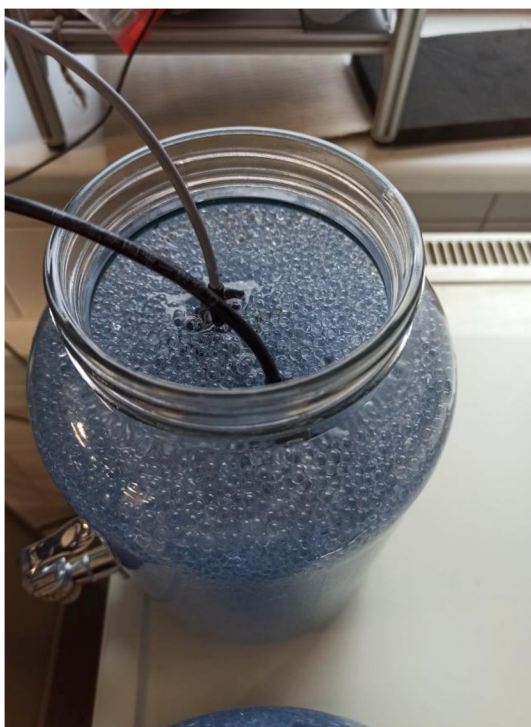
Obr. 4.9 Osazení čidel v nasycených kuličkách
