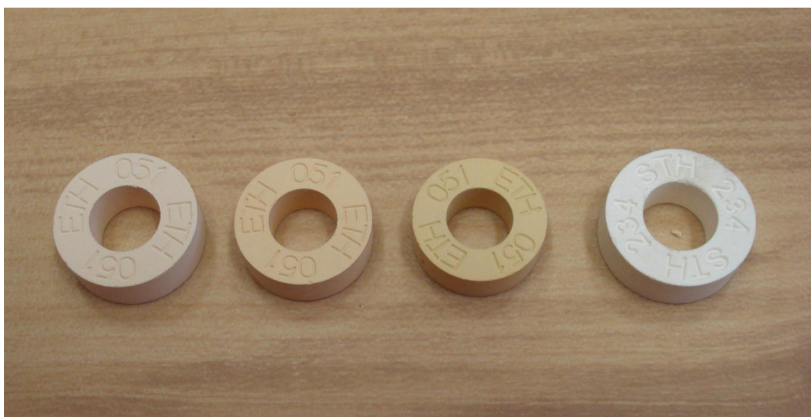
Obr. 18. Smrštění použitých PCTR po výpalu.
