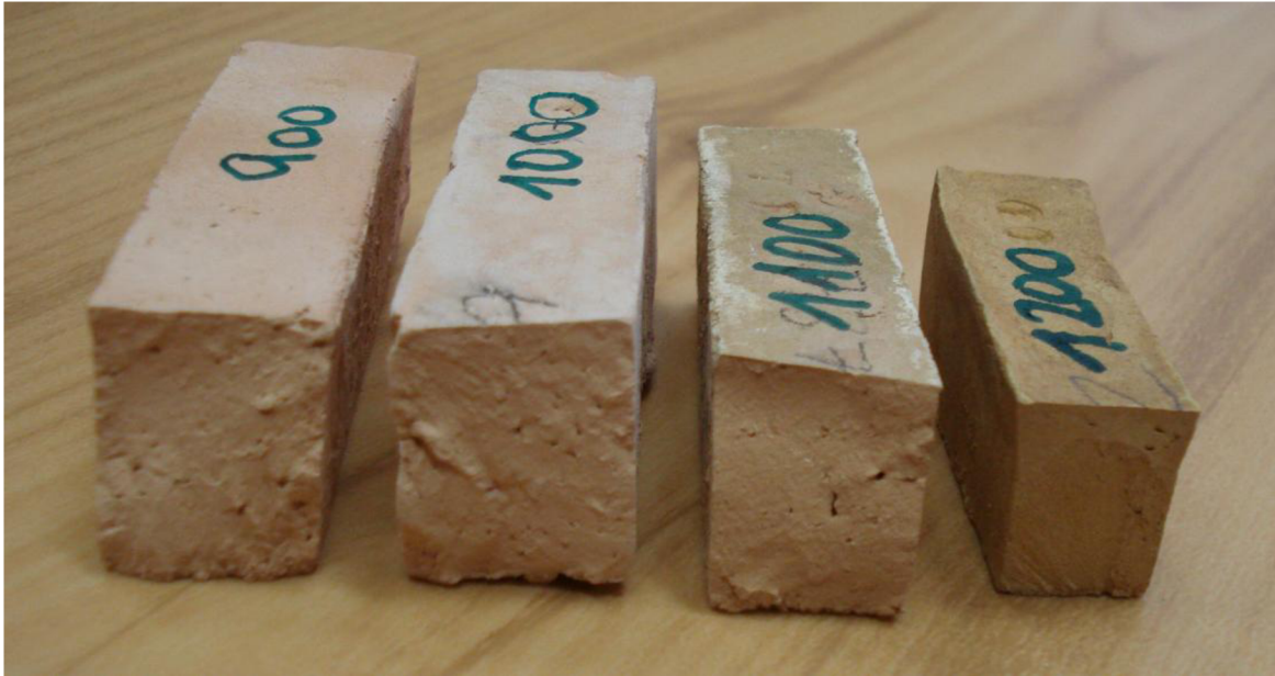
Obr. 19. Snížení objemů vzorků v závislosti na teplotě.
