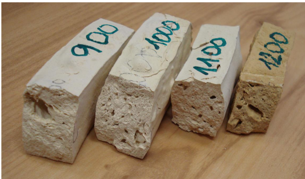
Obr. 20. Změna pórovitosti s nárůstem teploty.
