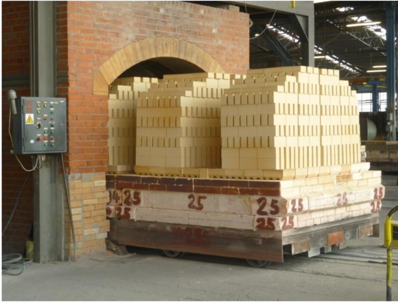
Obr. 3. Tunelová pec pro kontinuální výrobu.
