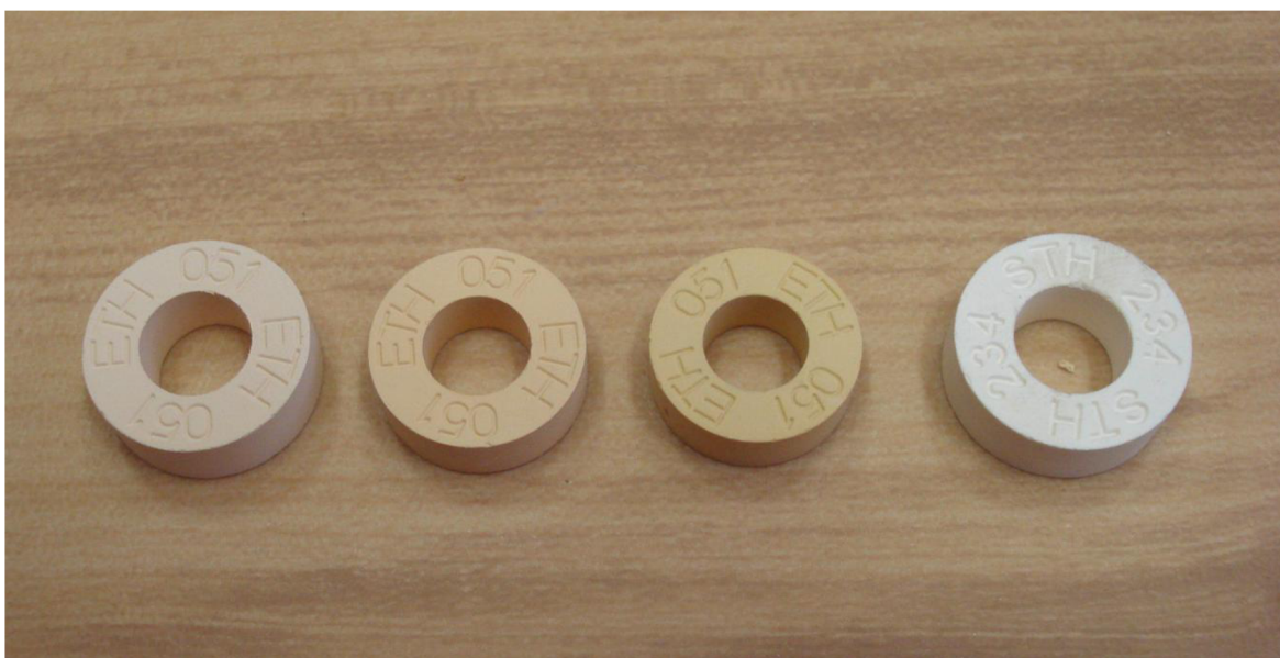
Obr. 18. Smrštění použitých PCTR po výpalu.
