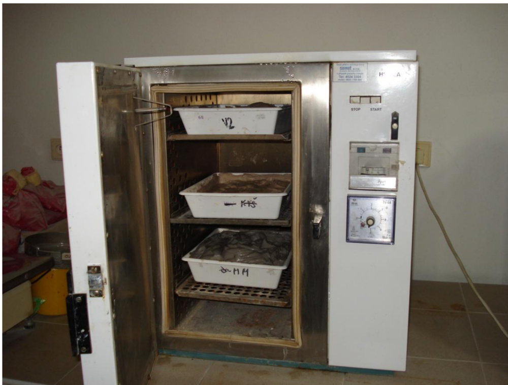
Obr. 16. Sušení suspenze na plastické těsto.
