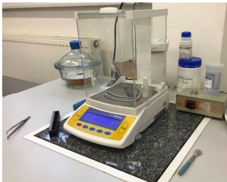
Obrázek 21: Laboratorní váha Sartorius SP124 S
