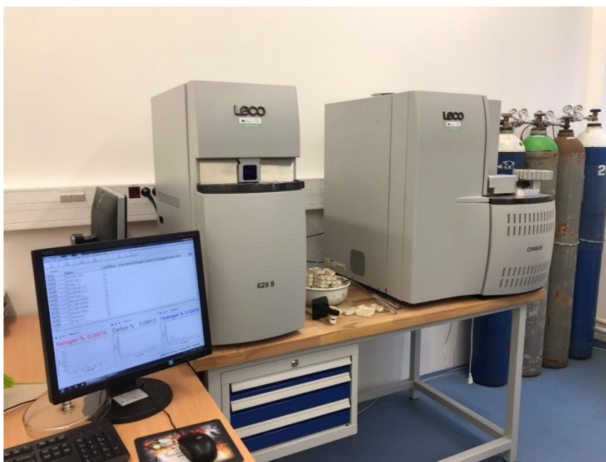
Obrázek 25: Analyzátor LECO CHN628+S (vlevo), Analyzátor LECO CHN628 (vpravo)
