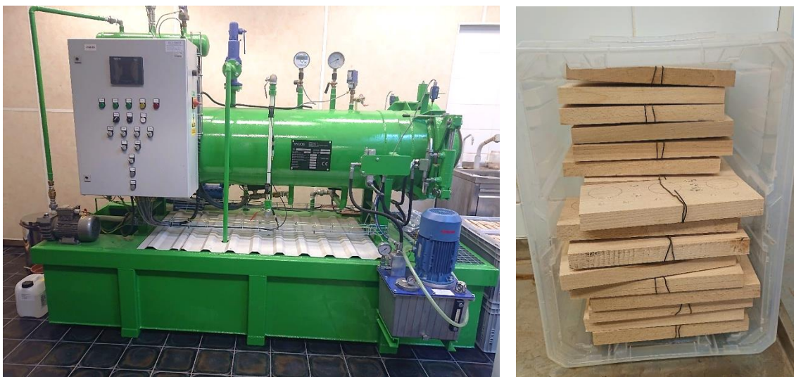
Obrázek 23: Příprava na chemickou modifikaci impregnační zařízení VTIZ (vlevo), tělesa připravená k impregnaci (vpravo)
