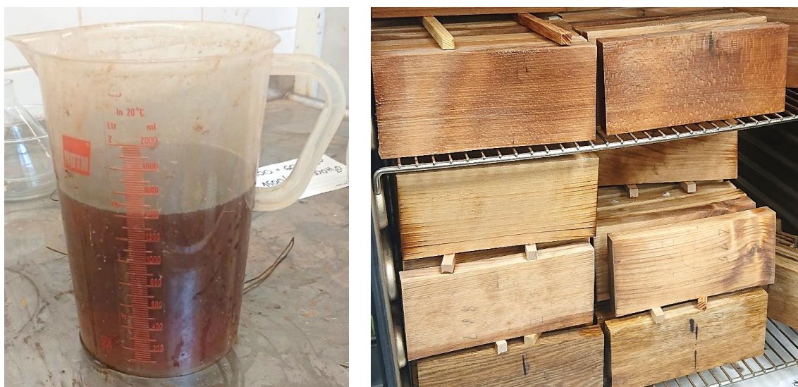
Obrázek 24: Výstupní produkty modifikace výluh pryskyřice (vlevo), impregnovaná tělesa před vytvrzením (vpravo)
