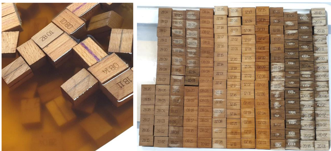
Obrázek 20: Tělesa pro měření bobtnání na konci máčení (vlevo), po ukončení měření (vpravo)
