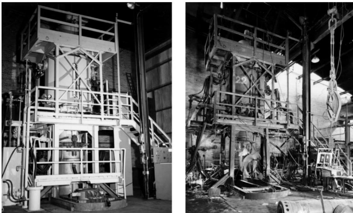
Obr. 21 Stav pece před a po explozi [23]
