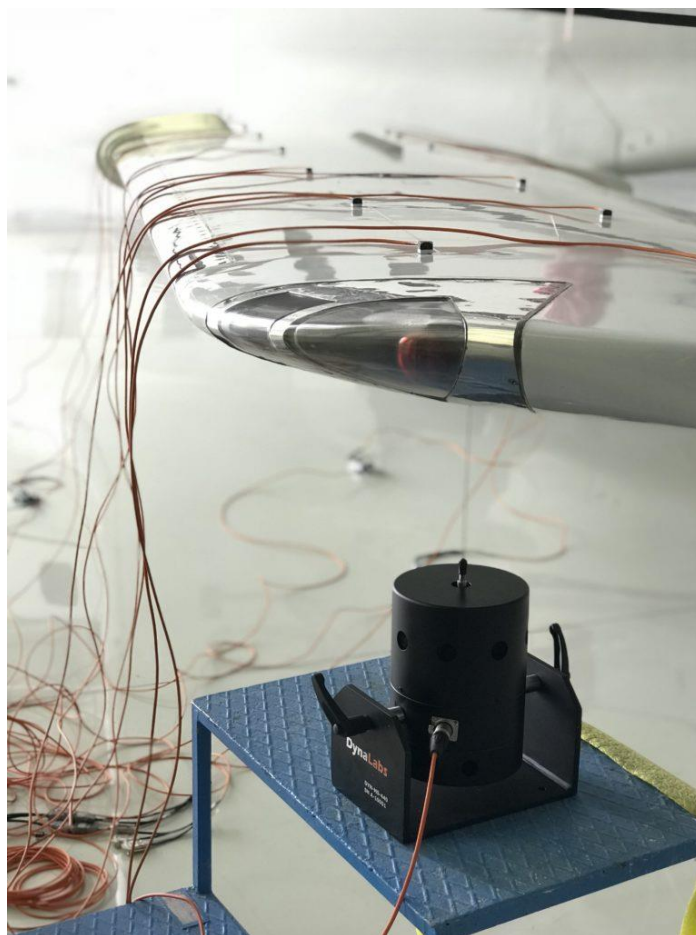
Obr. 2.3–křídlo letadla přichystané k rezonanční zkoušce [4]
