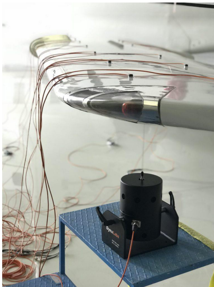
Obr. 2.3–křídlo letadla přichystané k rezonanční zkoušce [4]
