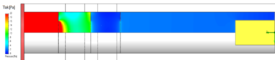
Obr. 6.41 Rozložení tlaku při tlaku 200 Pa v komoře vzorku Clonky č. 4 (0.05 mm, 300 ok, hexagonální)
