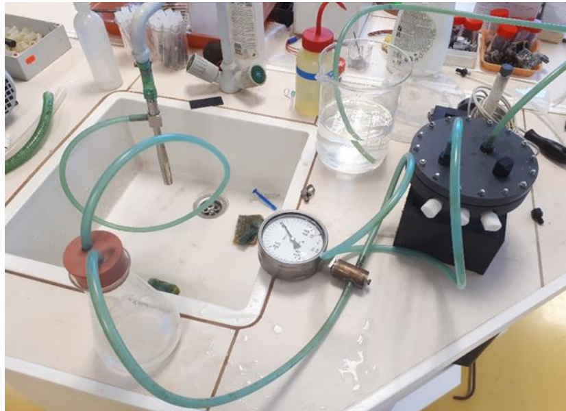
Obrázek 3.4 Zapojení systému pro nasávání gelového elektrolytu
