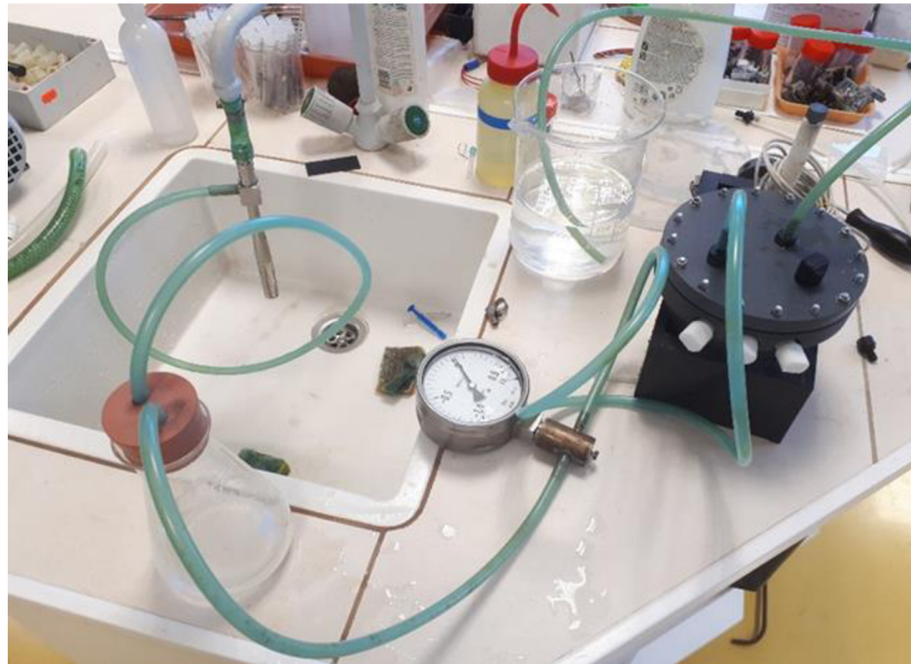
Obrázek 3.4 Zapojení systému pro nasávání gelového elektrolytu
