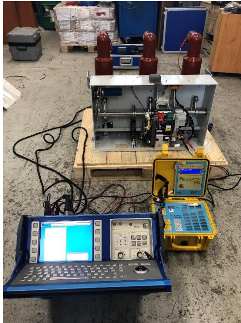
Obr. 8.3 Meranie zapínacích a vypínacích časov VD4.
