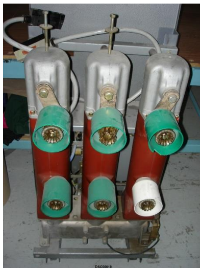
Obr. 3.3 Vypínač VF ABB plnený plynom SF 6 .
