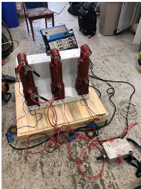
Obr. 8.2 Meranie prechodových odporov na VD4.
