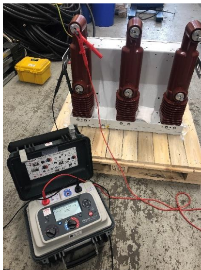
Obr. 8.1 Meranie izolačných stavov.
